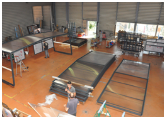
▲ Des matériaux de grande qualité : profilés en aluminium thermolaqué label Qualicoat et QualiMarine - plaques en polycarbonate 8 mm traité anti-UV double face.
