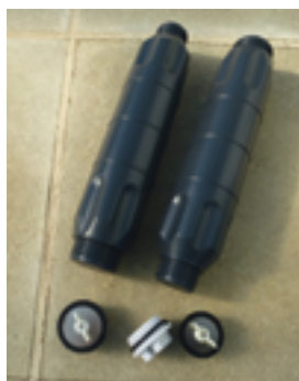
Bouchons pour les bouches de refoulement et gizzmo pour protéger les skimmers.
