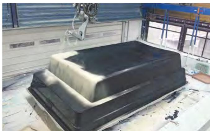
Chez Piscines Ibiza, les coques sont réalisées selon la technique de projection simultanée de la résine, du catalyseur et de la fibre de verre. Contrairement à la fabrication « au contact », cette technique permet une imprégnation maximale des différentes matières premières. Ce procédé exclusif a l'avantage d'assurer une parfaite régularité d'application et par conséquent, une qualité constante.
