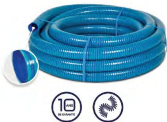
Le NOVOFLEX et le NOVOFLEX AC ont le rayon de courbure le plus petit de la gamme, avec en plus un stabilisateur de température qui maintient la souplesse du tuyau même à basse température ( $\geq 5^{\circ}\text{C}$ ) - ils sont donc idéals pour les constructions en hiver. Les deux tuyaux sont renforcés par une spirale en PVC rigide qui permet une haute résistance à l'écrasement - ils restent souple mais robuste !
