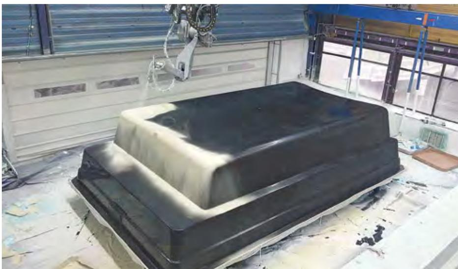
*La fabrication robotisée, exclusivité Piscines Ibiza, permet d'accroître la qualité et l'homogénéité d'épaisseur des coques.*
