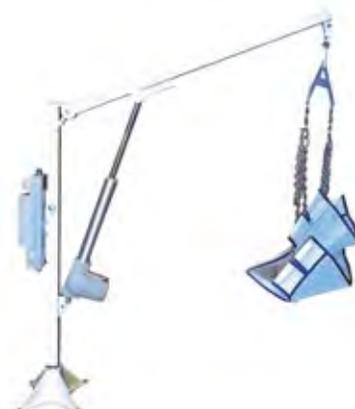
*L'unifex d'Hexagone est constitué d'une colonne pivotante articulée avec une tige repliable. Il est capable de supporter un hamac, un siège rigide ou un fauteuil submersible. Amovible et pivotant sur 360°, il intègre 2 batteries dont 1 de rechange (30 mouvements), d'un boîtier de commande avec sa poignée étanche et d'un chargeur mural.*
