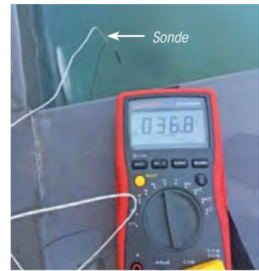
Contrôleur électrique équipé d'une sonde PT-100
