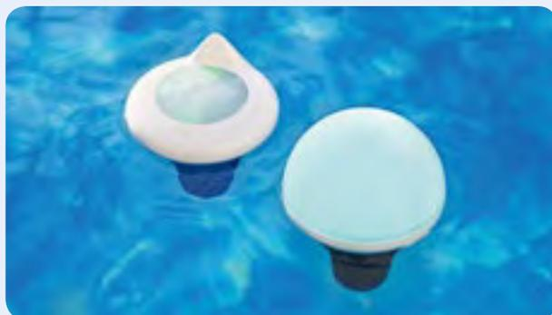
**OFI (Objet Flottant Intelligent) d'ASAMGO :** à l'aide de 4 sondes (pH, Redox, conductivité et température), les données concernant le niveau de chlore/brome, sel, et dureté de l'eau sont calculées et transmises par le réseau Bluetooth ou Sigfox.
