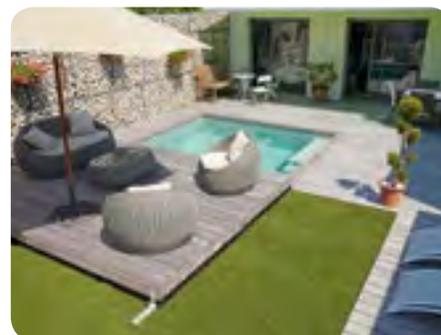
**type de bassins**, celle-ci peut être conçue en deux parties symétriques ou non, pour une largeur maximale de piscine de 5 mètres et une longueur maximum de 12 mètres. **Elle supporte une charge jusqu'à 120 kg/m².** L'ouverture/fermeture de la terrasse peut s'effectuer de façon manuelle ou par un moteur à alimentation solaire.
