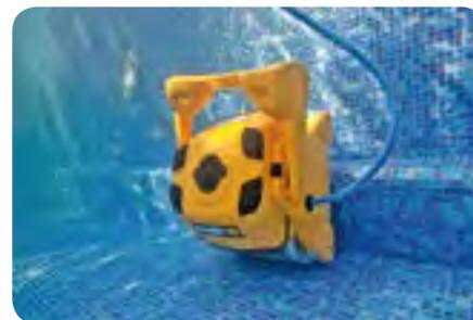
*Wave 100 - Nettoyage efficace et totalement automatique de piscines d'hôtels, de campings et de tous types de piscines collectives. Le système gyroscopique avancé assure un balayage total pour une couverture systématique du sol, des parois et de la ligne d'eau.*
