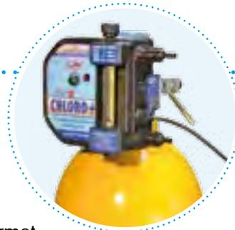
Le chloromètre est un doseur qui permet d'injecter du chlore gazeux dans l'eau, de manière sécurisée, afin de traiter notamment l'eau des piscines. Le chlore gazeux est la forme de chlore la plus pure et la plus stable et ce système est parmi les plus simples du marché à utiliser. Avec ce type d'appareil, le chlore n'est pas sous pression mais en dépression, rendant impossible une fuite de chlore gazeux sur le réseau d'injection.
