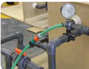
Mise en pression d'eau (mano) pour contrôle de l'hydraulique réalisée.
