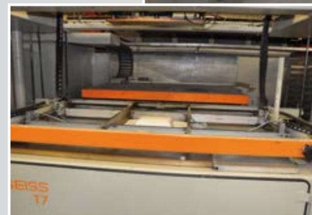
Four de thermoformage pour les cabines hammams Thermoforming oven for steam rooms (hammams)
