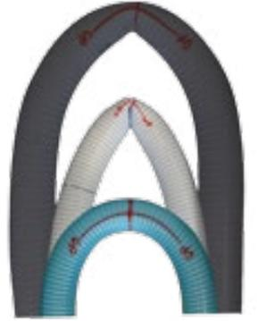
Test del raggio di curvatura
