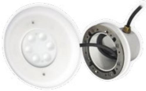
Disponibile nei modelli FIX COLOR (colore fisso bianco), ONDE CONVOGLIATE (cambia colore RGBW con 2 fili) e DMX (cambia colore RGBW con 5 fili); anche questo faro, come tutta la gamma di prodotti Teclumen per piscina e fontana, non necessita di driver esterni ma semplicemente di un trasformatore 12 V AC. La qualità dei materiali, corpo in acciaio AISI 316L e vetro frontale, ne garantiscono una lunga durata nel tempo. Il prodotto è coperto da una garanzia di 3 anni.
