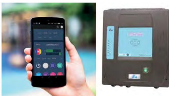
La filtration (premier contacteur du coffret) n'est plus une contrainte pour l'utilisateur, grâce à une gestion automatique via la sonde de température fournie avec le coffret. Une gestion qui permet également de protéger le circuit hydraulique de la piscine du gel.
