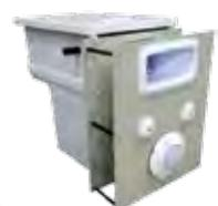
filtrer l'eau des piscines jusqu'à 10 x 5 m (80 m³). Equipé d'une pompe puissante, de grandes cartouches filtrantes (6 m² de surface de filtration) une aspiration basse, un skimmer grande meurtrière, 2 buses de refoulement orientables, un projecteur LED couleur avec télécommande. Capot amovible avec sécurités mécaniques. Options de Bypass (pH, électrolyseur).
