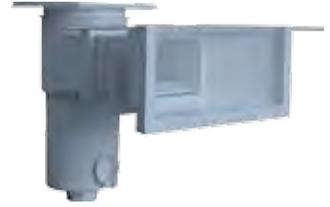
Il est conçu en ABS traité anti-UV spécial piscine, avec deux joints autocollants en élastomère faciles à installer (résistants aux produits chimiques), ainsi qu'une visserie entièrement en inox adaptée à tous les types de bassins (liner ou béton). Il est pourvu d'un trop plein sécable.
