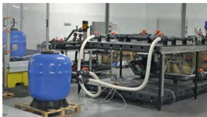
Le banc d'essais Procopi, ici pour le calcul des pertes de charge.
