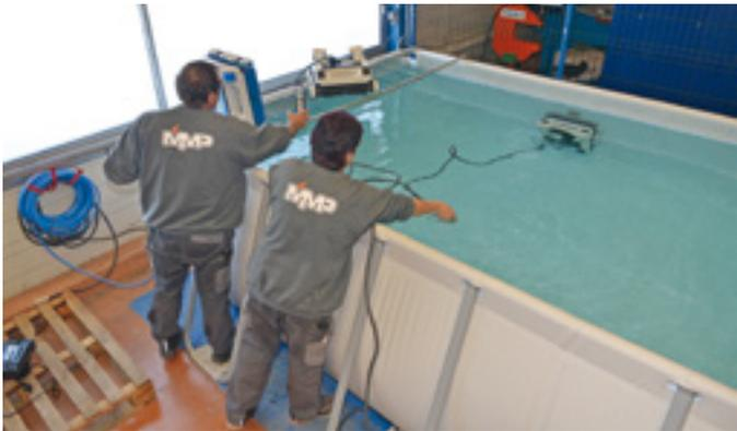
Les robots sont testés à leur arrivée dans un bassin spécialement affecté au SAV
