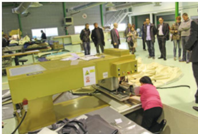
Soudure haute fréquence électronique d'un liner
