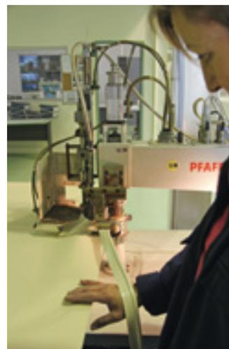
Poste de soudure du rail d'accrochage liner
